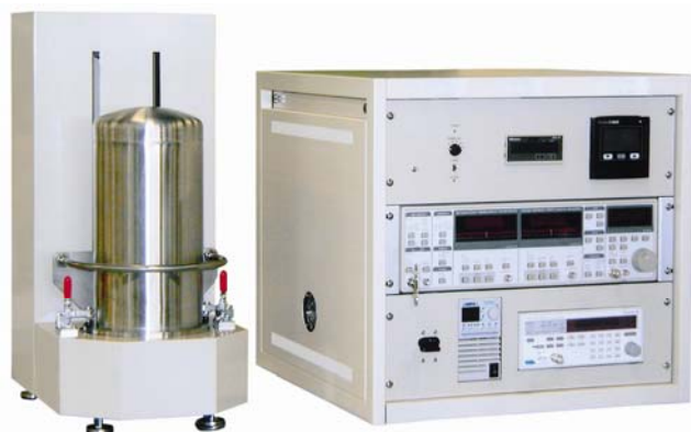
FTC-1 アルバック理工社製 (周期加熱法熱拡散率測定装置)
